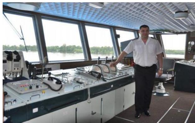
Von der Kapitänsbrücke aus wird das Schiff navigiert. Am zentralen Steuerpult befindet sich das Steuerruder, mit dem das Schiff gesteuert wird. Außerdem gibt es links und rechts zwei parallele Steuerpulte, die beim Anlegen und Manövrieren benutzt werden. Im Bugteil befindet sich das Bugstrahlruder, mit seiner Hilfe legt das Schiff an, manövriert und passiert die Schleuse. Die Gebühr für die Schleusendurchfahrt variiert je nach Größe und kann bis 5.000,- Dollar betragen.
